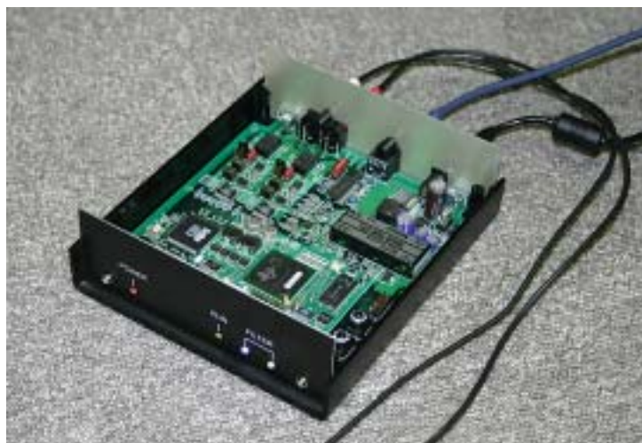
本理論により設計された超高域170kHzまで復元可能なCD用DAコンバータ
