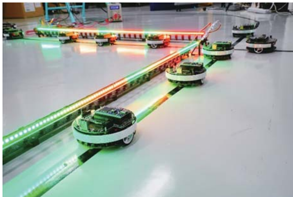
図3 リニア信号機による車両の制御
