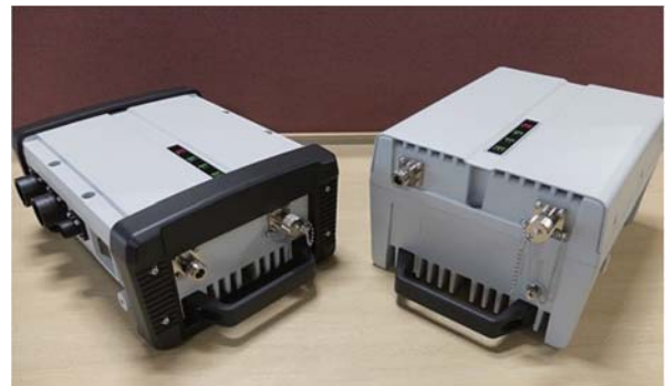
図3 開発した広域ブロードバンド通信用無線機
