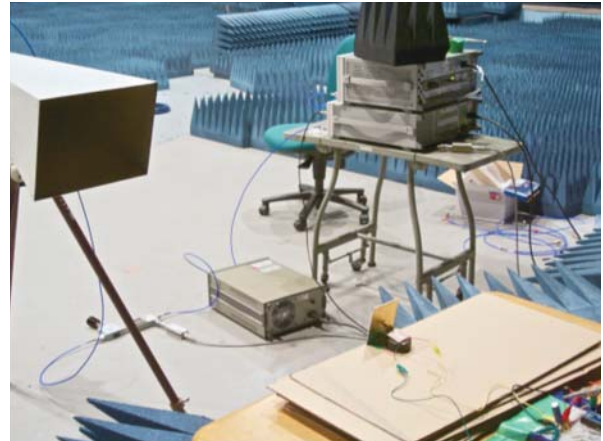
図6 無線 LAN と無線電力伝送の周波数共用実験
